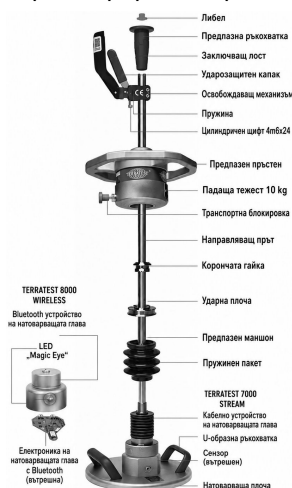
Фиг. 1. Устройство на динамичната щампа.
