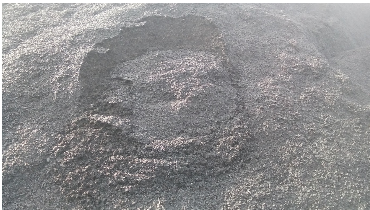
Фиг.2. Образувана коричка, която се е запазила след свличане на купа
