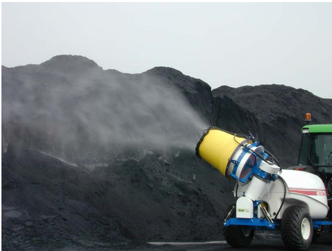
Фиг.3. Използване на специализирано водно оръдие с водоноска, производство на РАМ Енвиронман АД, Франция
