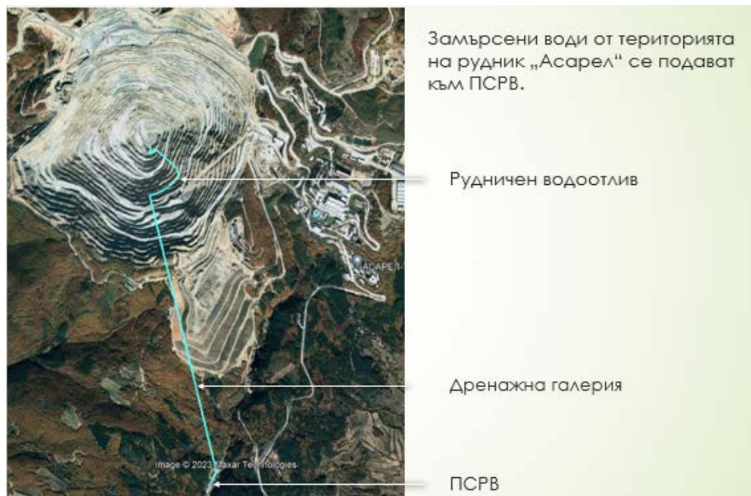
Фигура 3 - Схема с местоположението на рудничен водоотлив, дренажна галерия и ПСРВ.
