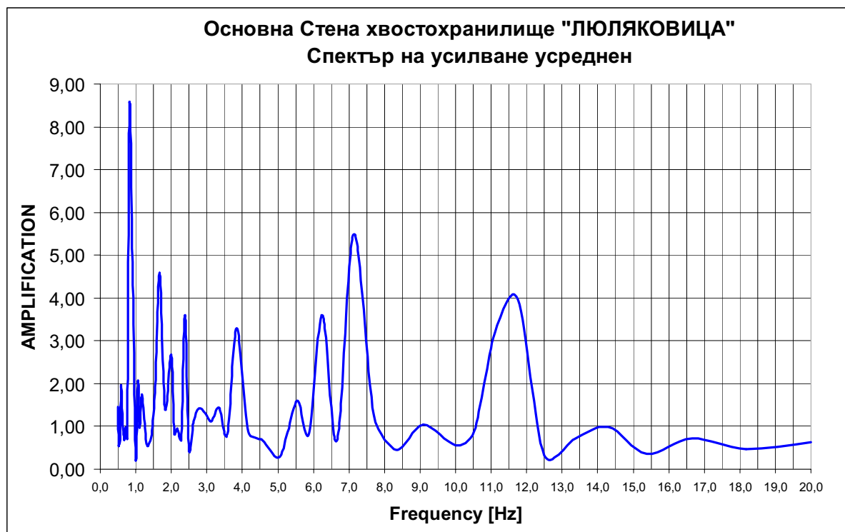
Фигура 6. Усреднен спектър на усилване на основната стена
