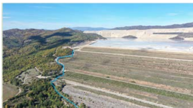
Фигура 6 – Трасе на западен отводнителен колектор
