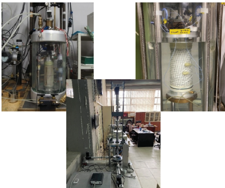
Фиг. 9. Цикличен триосов апарат с бендер-елементи и цикличен торсионен апарат с бендер-елементи (Лаборатория за редуциране на риска от геотехнически бедствия към Токийски университет – Токио, Япония), съответно ляво и среда, и цикличен мултипосочен апарат за плоскостно срязване (Middle East Technical University, METU – Анкара, Турция), дясно
