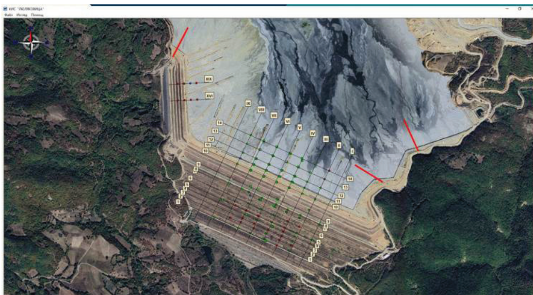
Фиг. 10 – Надграждане системата за подземен мониторинг – нови профили за следене на депресионната линия.
