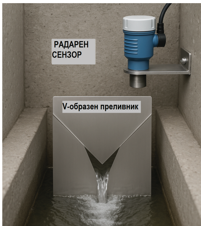
Фигура 6. Измерване на количеството на филтрация с V-образен преливник и радарен сензор
