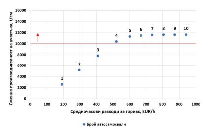
Фиг. 2. Избор на вариант за необходим брой автосамосвали въз основа на плановата средносменна производителност на участъка
