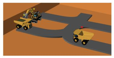
Фиг. 3. Работа на хидравличен багер при полукръгова схема на подаване на автосамосвалите (изглед от софтуерния продукт HAULSIM)
